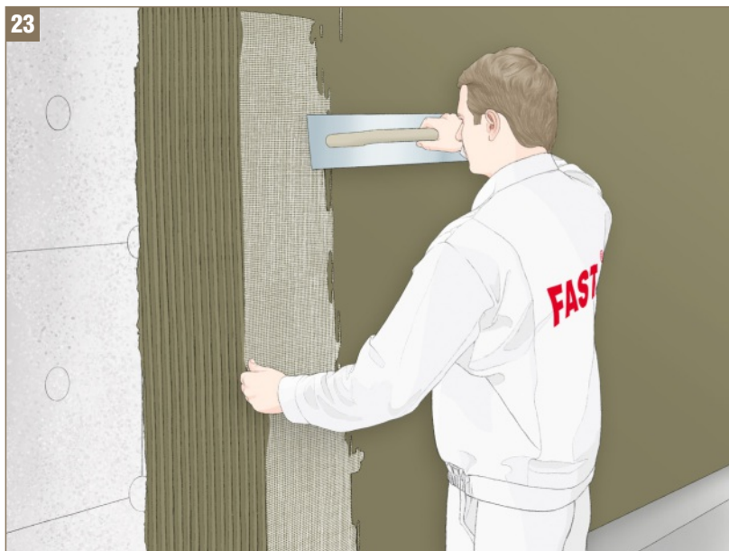
Rys. 23 - Zatopienie siatki w warstwie kleju
