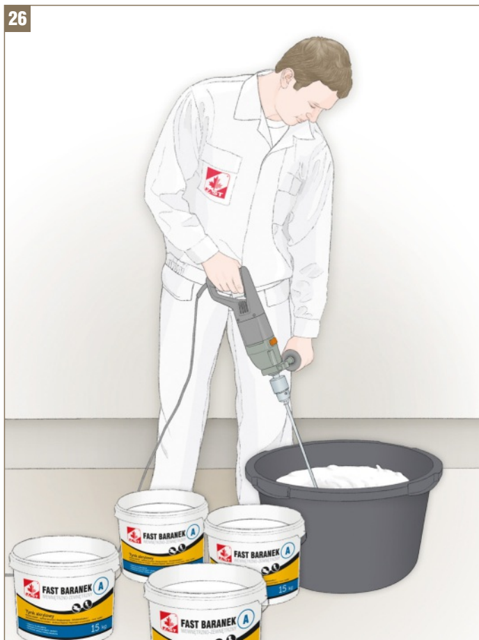
Rys. 26 - Przygotowanie mas tynkarskich przed nałożeniem (tynki akrylowe, silikatowe, silikonowe i siloksanowe)
