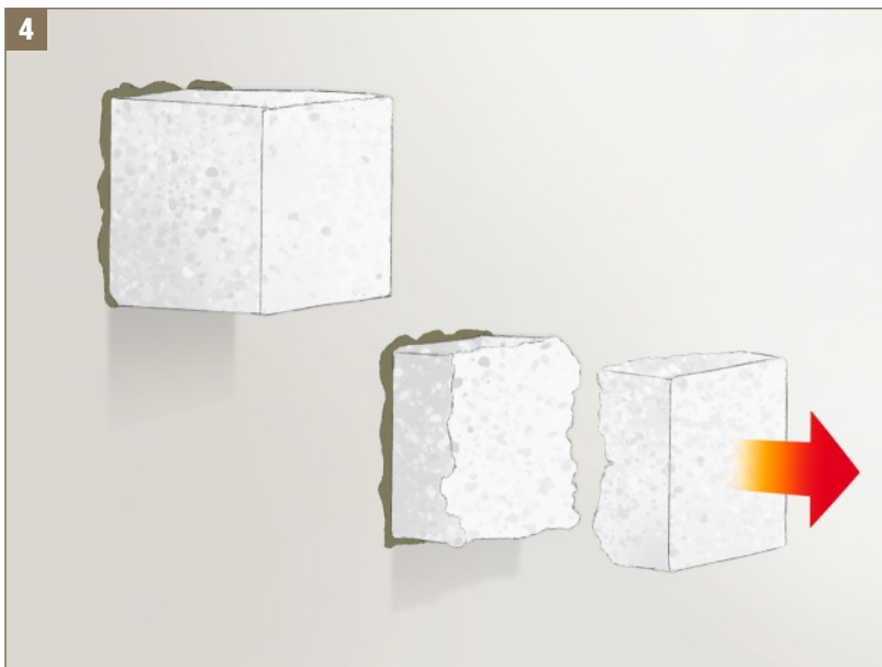
Rys. 4 - Sprawdzanie stanu nośności podłoża. Metoda PULL-OFF.
