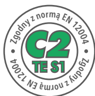
FAST EXTRA GEL Klej cementowy o podwyższonych parametrach, zmniejszonym spływie, wydłużonym czasie otwartym, odkształcalny
